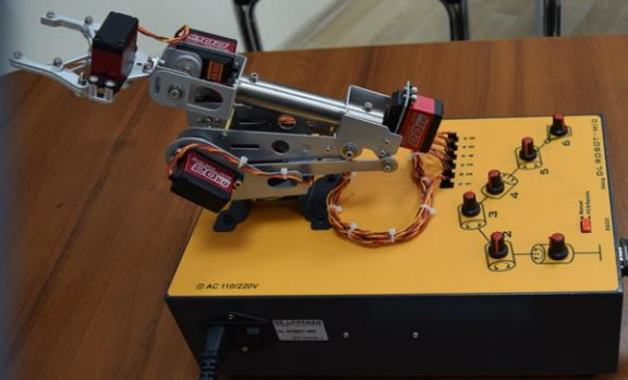
МАНИПУЛЯТОР-РОБОТ (управляван от микроконтролер)
